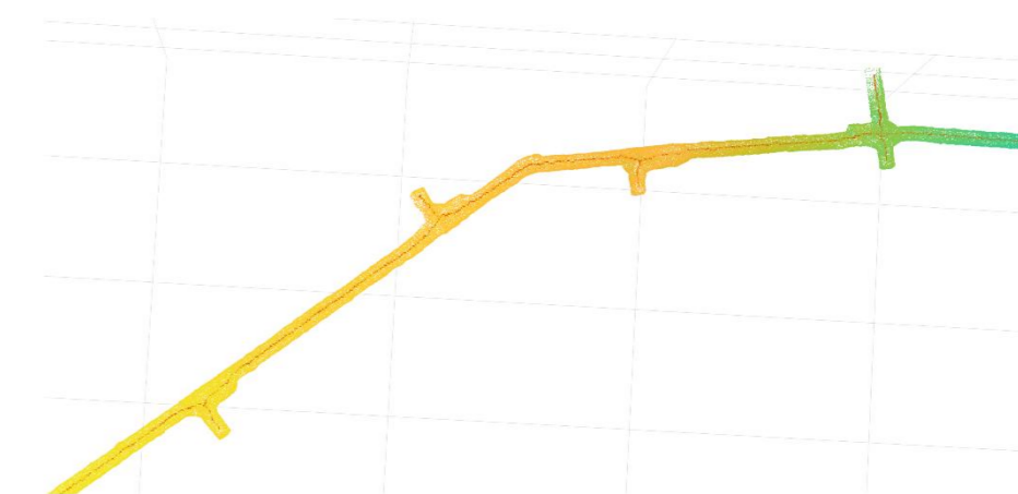
Rys. 4 Widok z góry na fragment przetwarzanej sieci wyrobisk wraz z wyznaczoną trajektorią
