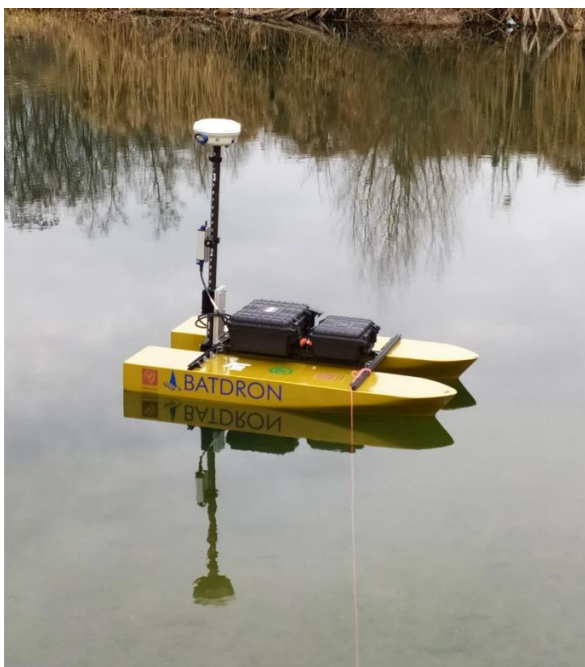
Rys. 1 Przykład zbudowanej jednostki pływającej używanej do prowadzenia pomiarów batymetrycznych
