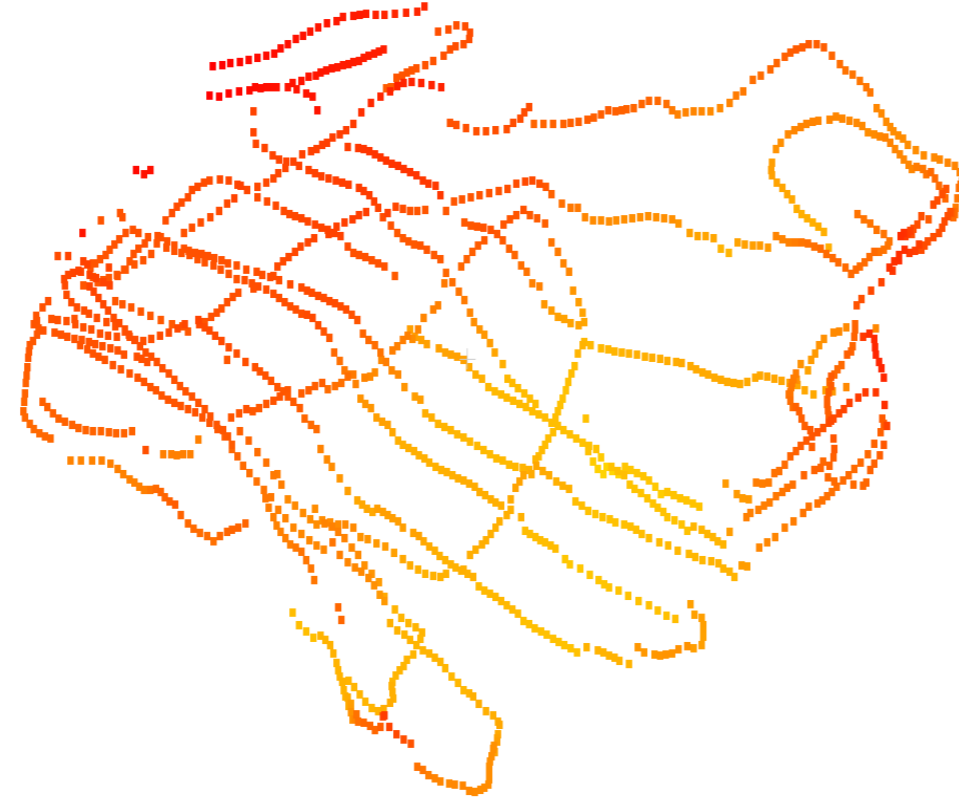
Rys. 2 Efekt pomiaru batymetrycznego z wykorzystaniem zbudowanej jednostki pływającej oraz sonaru jednowiązkowego
