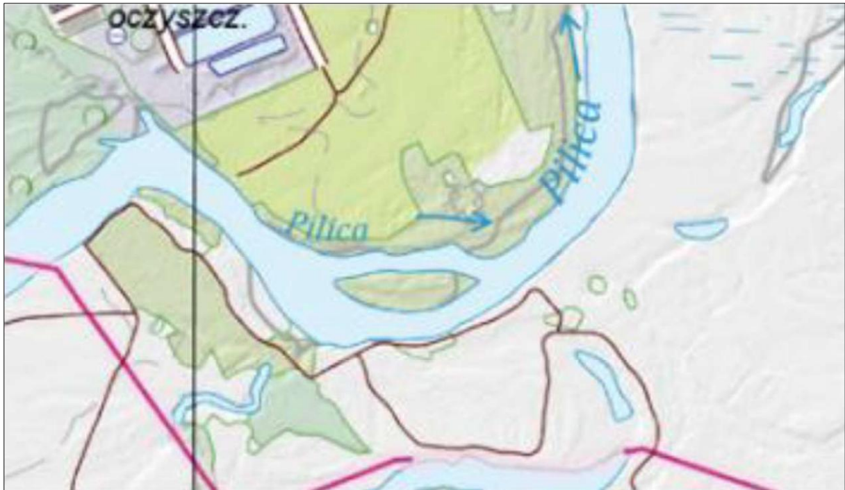
Arkusze M-34-007-C-b. Błąd w stosowaniu etykiet i ich rozmieszczenia: powielenie nazwy rzeki.
