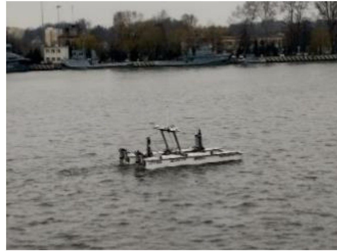
Rys. 1. Autonomiczna jednostka pomiarowa HydroDron-1
